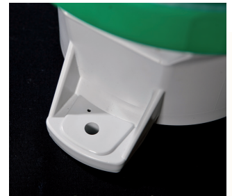
Instalación Se puede instalar en la estructura usando 3 pernos M6 en un diámetro de 150 mm.
