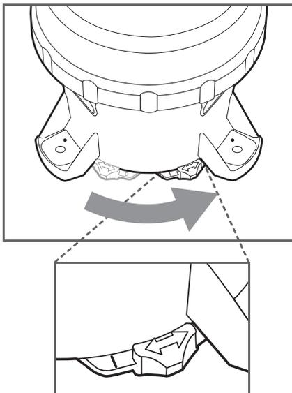
2. Para colocar el interruptor en posición de **Apagado**, deslice el interruptor hacia la izquierda hasta que se encaje en su posición. Cuando está en posición de **Apagado** hay un símbolo "O" visible en el interruptor.
