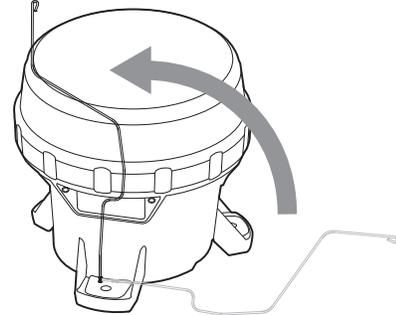
3. Gire el disuasor de aves en sentido horario hasta que el extremo en forma de L encaje en la ranura de la parte inferior de la pata de montaje. El disuasor de aves se extiende sobre la parte superior de la M650H para evitar que las aves aterricen en la misma.
