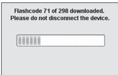
**No desconecte la linterna mientras se descarga la tabla de códigos de destellos.** Cuando el archivo se termine de descargar aparecerá la siguiente pantalla:
