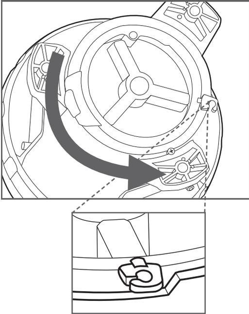
4. Levante y quite la cubierta empujando hacia arriba la lengüeta de sujeción que sobresale. Ahora puede acceder a los botones de la interfaz o al puerto USB (para utilizar el software 650 Device Manager). Este es también el primer paso al reemplazar la batería.
