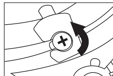
3. Asegure la M650H de modo que no se mueva y luego haga girar con firmeza la cubierta inferior en sentido antihorario unos 45 grados hasta que se detenga.
