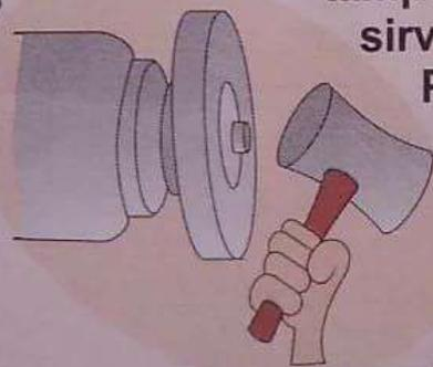
Não force o reboło durante a montagem na máquina, tampouco altere o furo do mesmo. Caso o reboło não sirva na máquina, utilize um reboło apropriado a ela. Para uso de bucha de redução siga as instruções especificadas nas normas (ABNT NBR 15230 - Brasil / ANSI B7.1 / EN12413).
